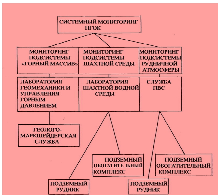
Принципиальная схема структуры мониторинга подземного горно-обогатительного комплекса / Schematic diagram of the structure of monitoring the underground mining and processing complex
